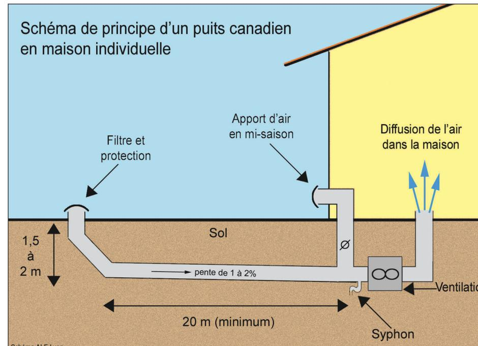
La conception d'un tel équipement se fait en fonction du volume et de la localisation géographique du bâtiment, du débit d'air nécessaire en hiver et en été, de la nature du sol, de la place disponible pour l'enfouissement des conduits et enfin du système de ventilation choisi (VMC simple ou double flux, aération naturelle...). L'entrée du puits peut se présenter sous différentes formes : à même le sol, dans un mur de soutènement ou encore sous la forme d'une tourelle. Dans la configu-
